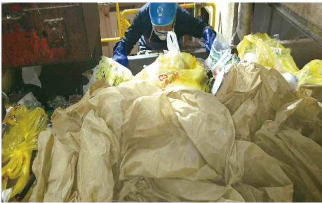
機械に絡みついた農業用ビニールを除去している作業員
