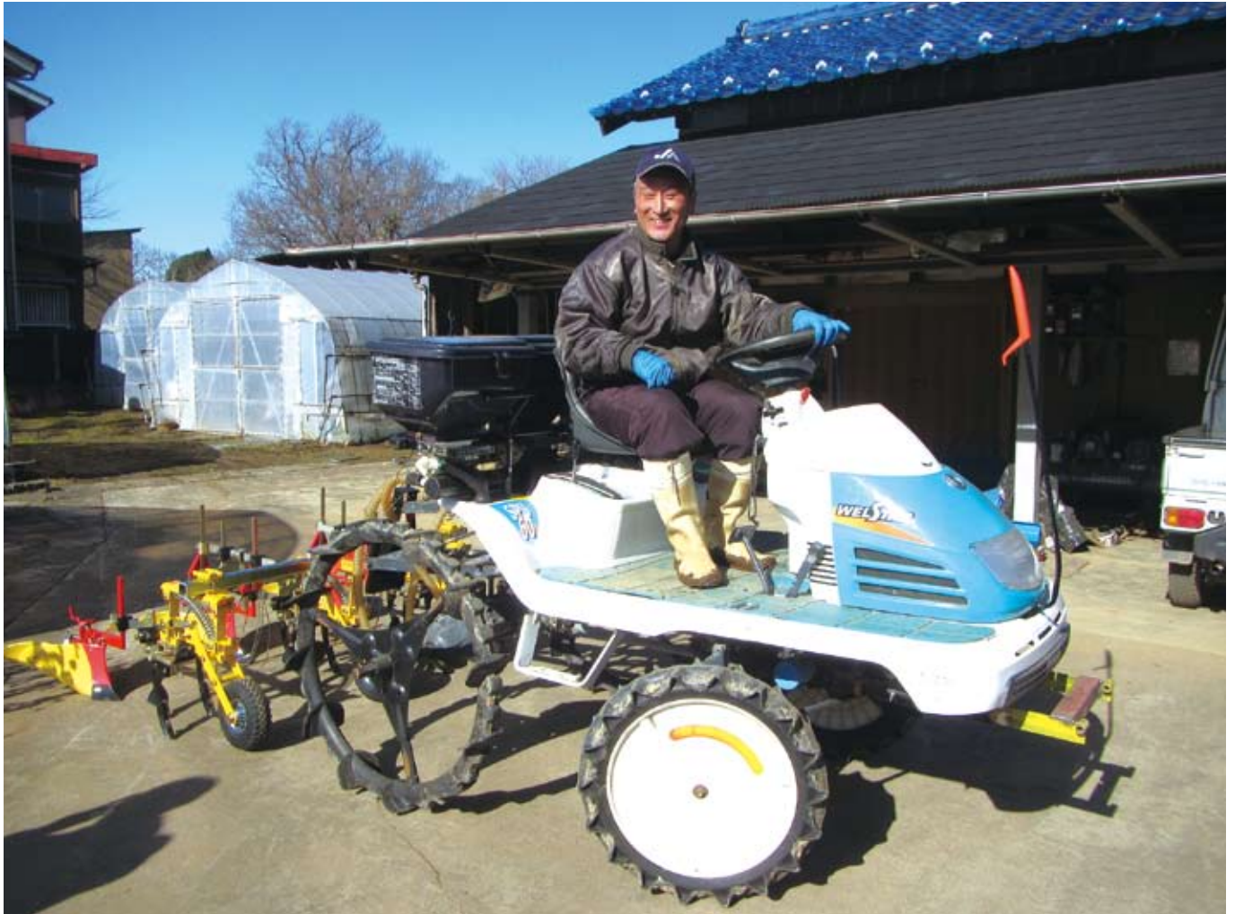
金山でJ A東葛ふたばの大根部会長を務めている鹿倉さん 中古の田植機を改良し、中耕除草機を自作しました。
