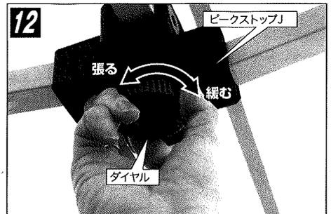
ピークストップの下についているダイヤルを回して、天幕の張り具合を調節します。
