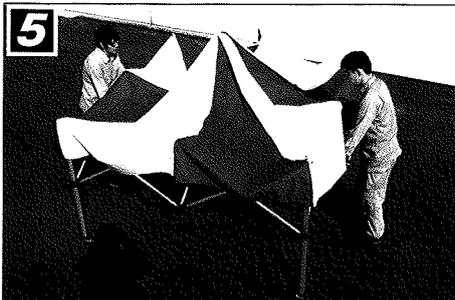
5 トラスパー下側のV字部分を持ち上げながら、さらに外側へ引っ張り、本体フレームを最大まで広げます。
