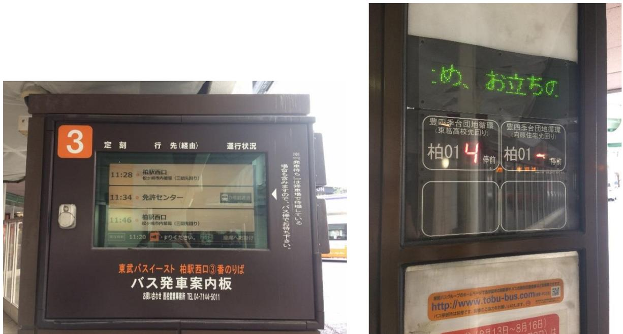
図 2-32 柏駅西口におけるバス停でのバスロケーションシステムによる到着時刻案内
