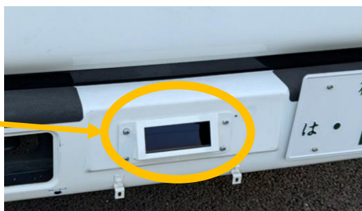
高解像度LiDAR (小物体・横臥者検知)
