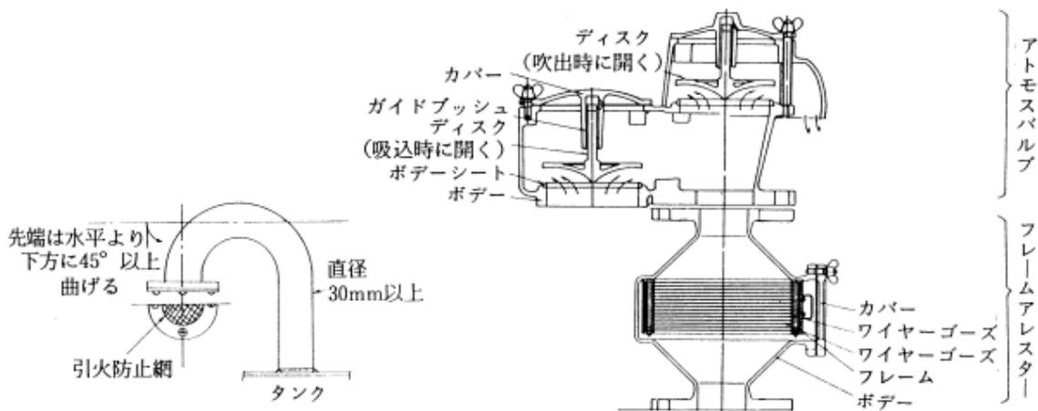
無弁通気管の例      大気弁付通気管（アトモスバルブ）の例
