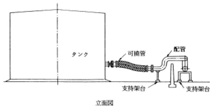
エ ベローズを用いる可撓管継手は、移送する危険物の性状に応じて腐食等のおそれのない材質のベローズを用いたものであること。
