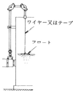
浮子式計量装置の例
