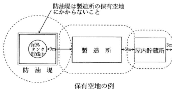
だし，隣接する製造所等が液体の危険物の屋外タンク貯蔵所であるときは，製造所に係る空地の幅は隣接する屋外タンク貯蔵所の防油堤の外側との間に空地を保有すること。（上図参照）
