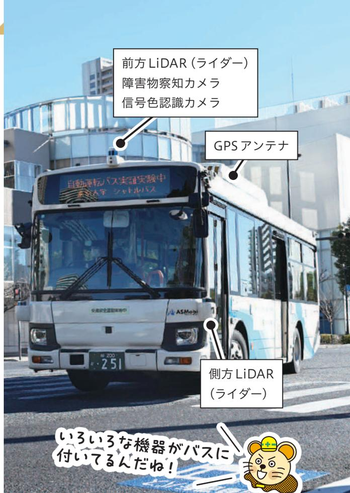
さらに、自動運転を可能にするにはバスの性能だけでなく、道路上などにも工夫が必要なんだそう。バスの位置はGPSで管理されていますが、木などの障害物により安定して電波が受信できない場合があるため、その対策として2~3センチメートルの小さな磁気マーカーを道路に埋め込み、位置を把握しています。他にも、路上駐車は特に自動運転の妨げになるので、路上駐車を抑制する路面標示を施したり、バスと車がすれ違いやすいように停止線の位置を変更したりと、自動運転バスをより安全に運行できる環境づくりを行っているといいます。
