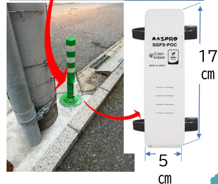
冠水発生時)冠水を検知すると、マークの色が変化
