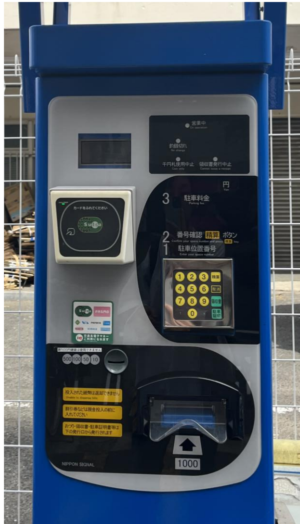
図 4-22 交通系 IC カードでの支払いに対応する駐輪場精算機
