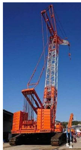
クローラータワークレーン
