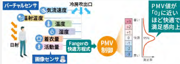
図 4-11 画像センサー等を用いた PMV 空調のイメージ
