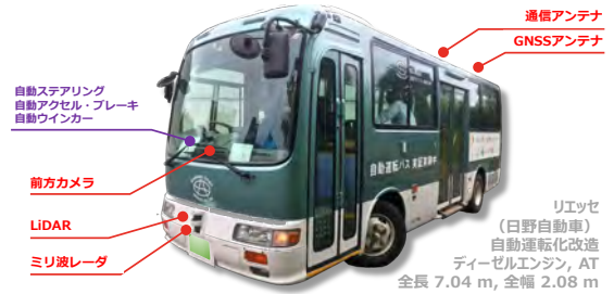
図 3-7 自動運転車両の運転システム概要
