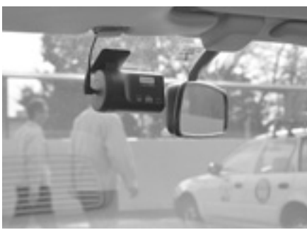
公用車に設置されたドライブレコーダー
