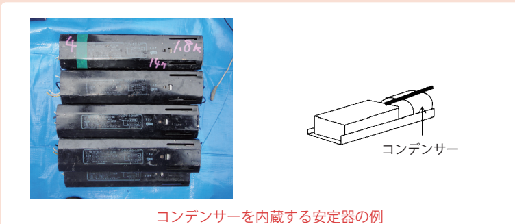
コンデンサーを内蔵する安定器の例
