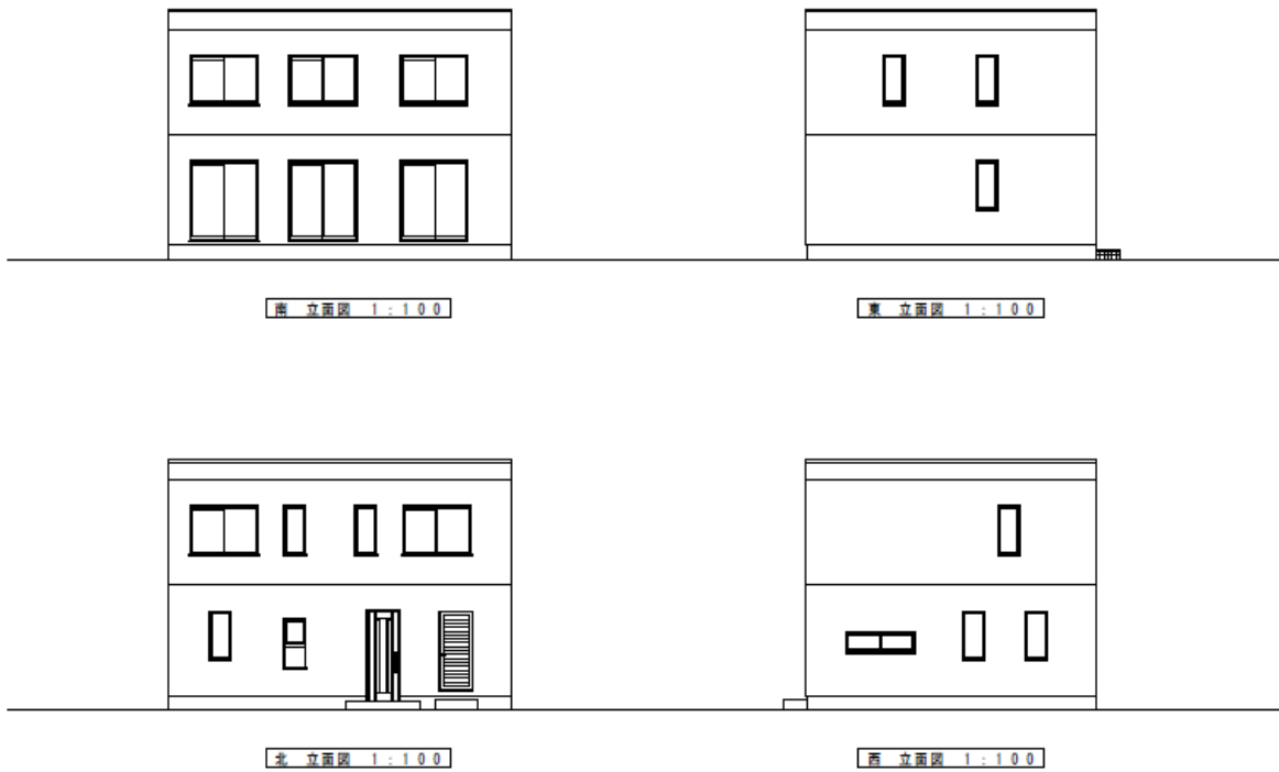
立面図(鉄筋コンクリート造)
