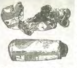
事故の原因となった小型ポンベ
