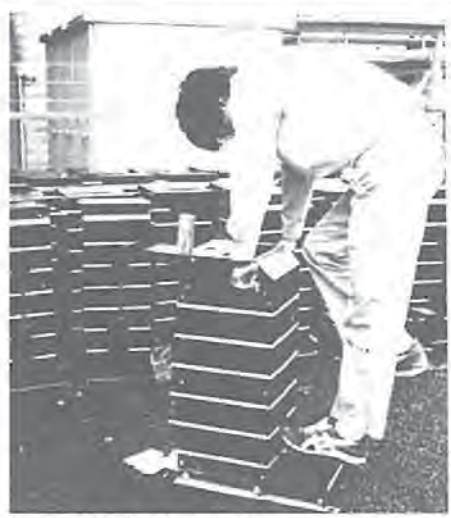
上から空き缶を入れペダルを踏むとプレスされて下から出てきます
