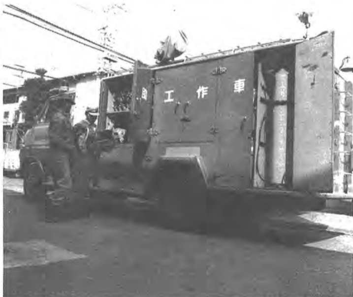
▶〈救助工作車〉 空気ボンベやエンジンカッターなどを積載。地震や火災の時はもちろん、自動車事故で人が車内に閉じ込められた場合などにも活躍します。
