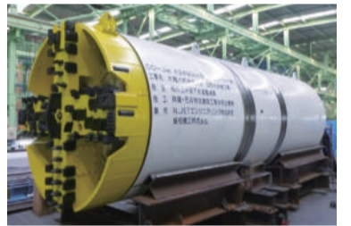
▲下水管を造る「シールドマシン」
