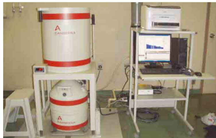
北千葉広域水道企業団のゲルマニウム半導体核種分析装置
