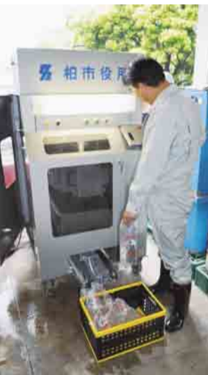
非常用飲料水パック装置
